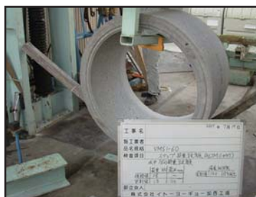
水平方向荷重試験 (異常なし)
