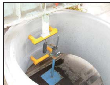
垂直方向荷重試験 (歪み5.4mm)
