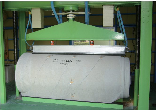
▼外圧強さ試験状況
